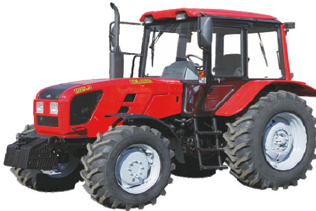
Трактор предназначен для выполнения различных сельскохозяйственных работ с навесными, полунавесными и прицепными машинами и орудиями, работ на транспорте.
