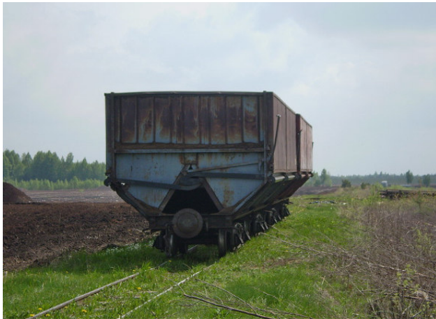
7 pav. Produkcija į gamybinį cechą gabenama siauriojo geležinkelio vagonais TSV-6A
