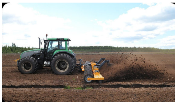
4 pav. Trupininių durpių frezavimas (www.vapo.fi)
