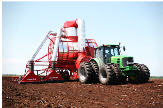
6 pav. Trupinių durpių surinkimas vakuuminiu surinkėju (www.premiertech.com)
